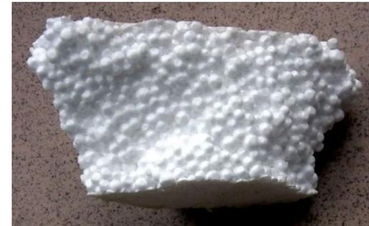
EPS – Querschnitt / Struktur
